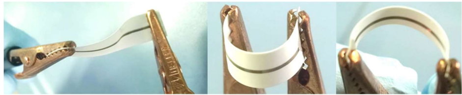
Abbildung 1: Darstellung des Ablaufs der 250 Zyklen des Beugens und Streckens der gedruckten Leiterbahn.
