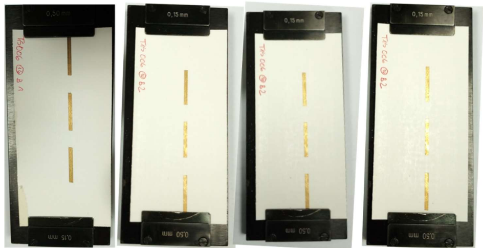
Abbildung 46: Aufnahmen der T1S_006-Proben vor (links) dem Scheuertest, nach 50 (zweiter von links), 100 (zweiter von rechts) und 300 Scheuerhübe (rechts).
