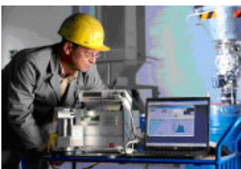
Messung von Nanopartikeln mit einem WRAS Messsystem (SMPS+OPC) im Arbeitsplatzbereich von 5nm bis 30 µm (Quelle: Fa. Degussa)
