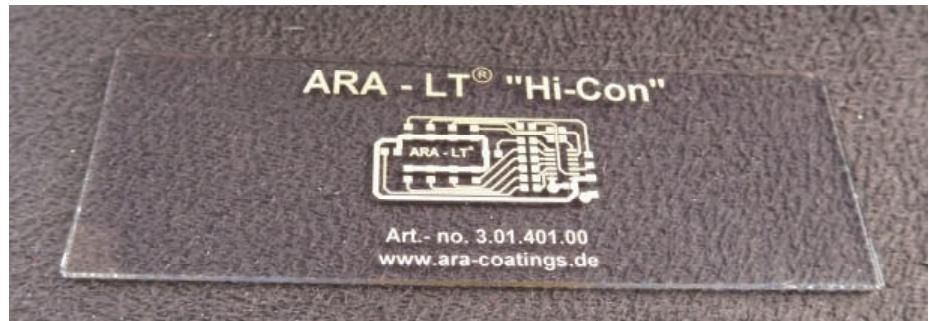
Aufgelaserte Leiterbahnen auf Glas. Bild: Ara-Coatings.
