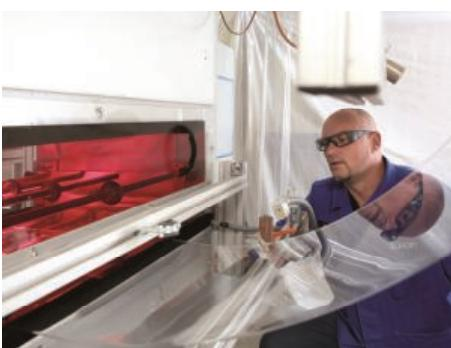
SCHOTT fertigt ultradünne Gläser im sogenannten Down-Draw-Verfahren. Dabei wird das Glas kontinuierlich aus der Schmelzwanne durch eine Düse direkt nach unten zu einem Glasband gezogen. Dieses wird dann für die weitere Verarbeitung auf Rollen aufgewickelt. Bild: SCHOTT.
