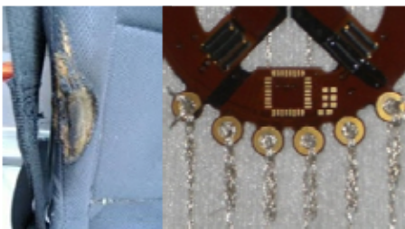
Bild 1 (links): Im Internet veröffentlichte Unfälle mit Sitzheizungen ( http://www.zroadster.com/forum/index.php?threads/brandloch-im-beifahrersitz-woher-kommt-sowas.20998/ ). Rechts im Bild: Im BMBF-Projekt SEATSEN von den Partnern AUDI AG, Car Trim GmbH, CE-SYS GmbH, GEMAC mbH, TITV Greiz, Würth Elektronik GmbH & Co. KG entwickelter anstickbarer Sensor mit ASIC, der die erfassten Daten bereits vor Ort digitalisiert. Bilder: TITV Greiz.
