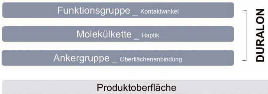
Prinzipieller Aufbau der Materialien der DURALON-Produktreihe. Bild: COTEC.
