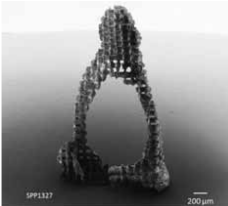
Additiv gefertigter Steigbügel in einem ORMOCER®-Material. Bild: R. Houbertz und T. Stichel, DFG-Schwerpunktprogramm SPP1327.
