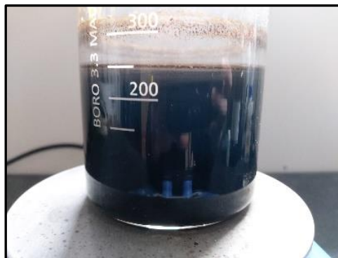
Abb. 3: Schwarzer, magnetischer Eisen(II,III)-oxid Niederschlag
