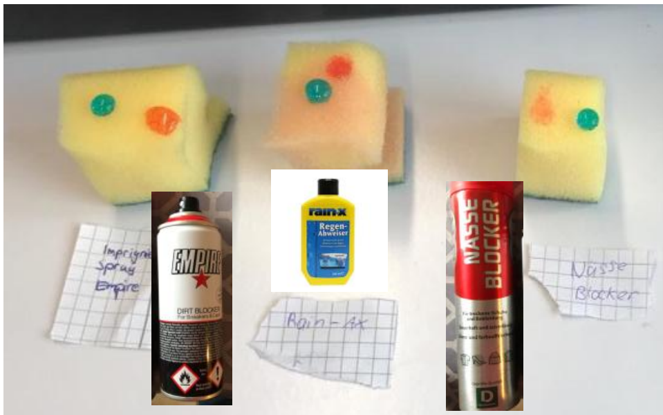
Foto 8: Öl- und Wassertropfen auf einem Haushaltsschwamm mit Imprägnierspray, Nässeblocker und Regenabweiser (Rainx) behandelt (Quelle: selbst erstellt)
