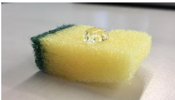
Foto 6: Unbenutzter Polyurethanschwamm mit Wassertropfen. Kontaktwinkel beträgt ca. 93° (Quelle: selbst erstellt)
