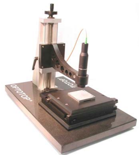
OptoTop®: Optisches Oberflächenmesssystem zur schnellen und berührungslosen Topografie- und Geometrievermessung im Nanobereich.
