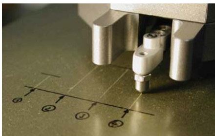
Kratztest mit dem UST® Gerät
