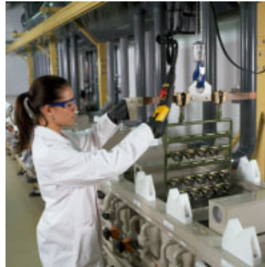
Galvanik-Entwicklungsanlage des Schaeffler Oberflächentechnikums, die insbesondere der Entwicklung umweltverträglicher Korrosionsschutzschichten dient. Bildquelle: Schaeffler
